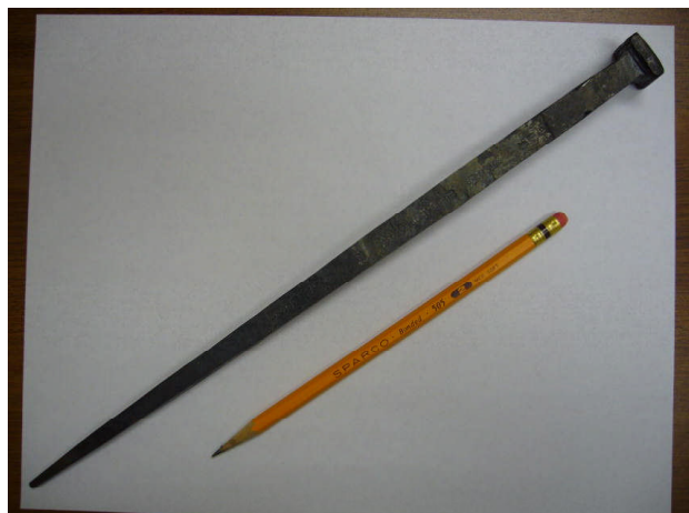
「千年もつ釘」と言われる白鷹さんが作った30センチ以上ある和釘
